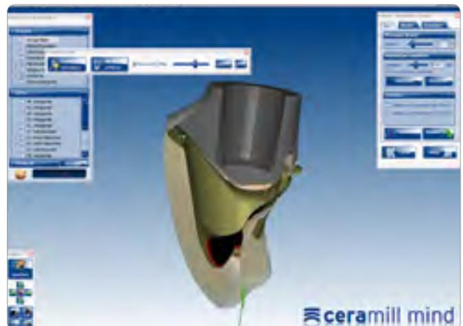
Abb. 16a und b Virtuelle Konstruktion der individuellen Abutments
